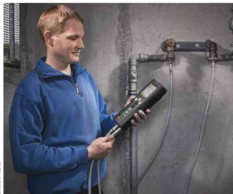
Einfache Gebrauchsfähigkeitsprüfung mit testo 324.
